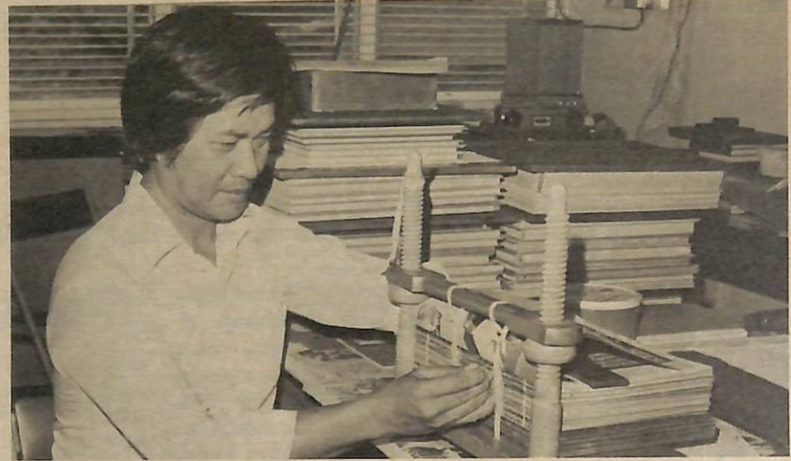
Untuk buku2 yang berkuras (section) biasa-nya di-jahit chara "tape-sewing" dengan menggunakan "sewing frame" dan manakala gambar bawah menampakkan proses casemaking dan sa-terus-nya memproses kerja2 "casing-in" ia-itu buku tersebut di-masokkan ka-dalam "case-nya".
