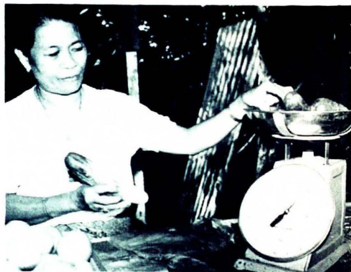
ALAT timbangan yang digunakan oleh makcik ini adalah salah satu contoh alat yang menggunakan 'dual sistem', iaitu sistem metrik dan imperial.
