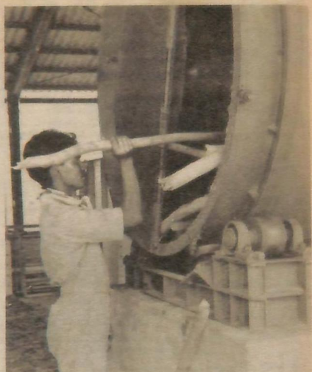
BATANG kayu yang sudah dipotong diproses dengan menggunakan mesin untuk memisahkan kulit dari batang.
